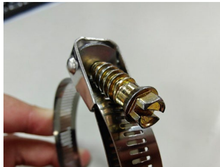
步驟三: 扣下鎖固螺絲，使用一字起子迫緊
