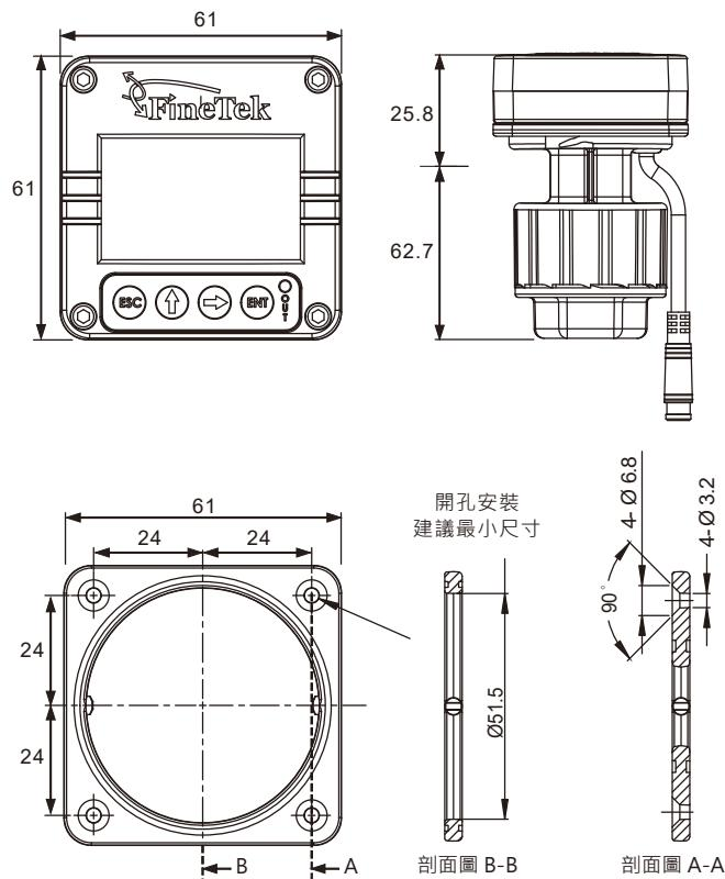
安裝盤上需依上圖剖面B-B於對角開直徑3.2mm的孔；
